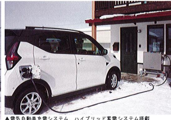
▲電気自動車充電システム、ハイブリッド蓄電システム搭載
